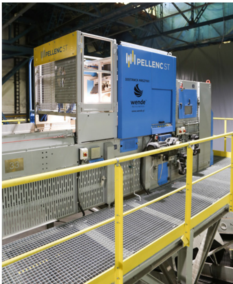
Najwięszy zastosowany w EKOPAK optosorter Pellenc Mistral+ Connect DVI 1200 służy do wysortowywania butelek PET z podziałem na trzy kolory.
