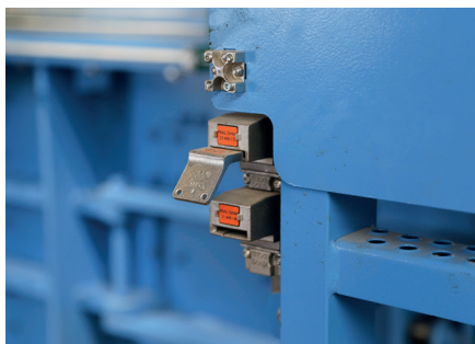
Rozwijacze drutu zostały przygotowane na duże wiązki o masie po 500 kg.
