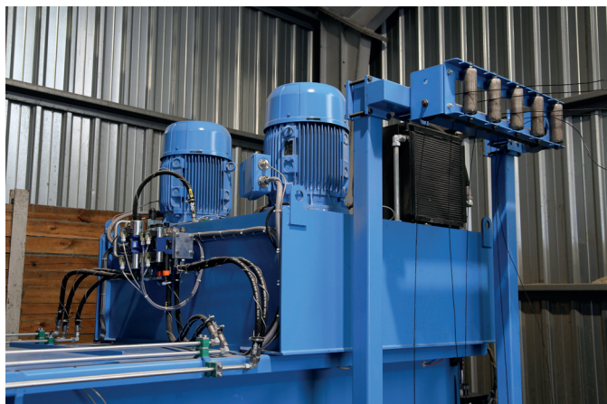
Belownica dostarczona do zakładu SUEZ zapewnia pionowe wiązanie z opasaniem 5-krotnym. Obecnie jest stosowany drut o średnicy 3,4 mm.
