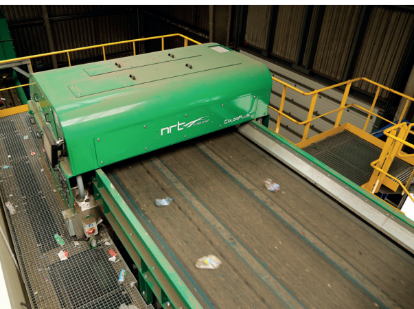
Separatorzy NRT mają postać jednoczęściowych boksów. Odbywa się w nich zarówno skanowanie i rozpoznawanie materiału, jak i wydmuchiwanie pozytywnych frakcji.
