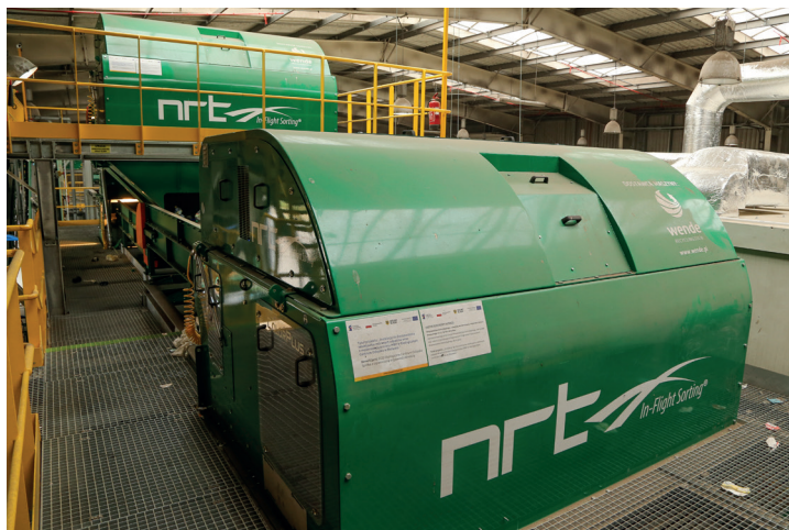
Zakład ECO Bielawa jest wyposażony w trzy separatory optyczne NRT. Dzięki technologii in-flight sorting nie muszą mieć długich przenośników przyspieszających, a tym samym cały zestaw takich urządzeń wymaga mniej miejsca.
