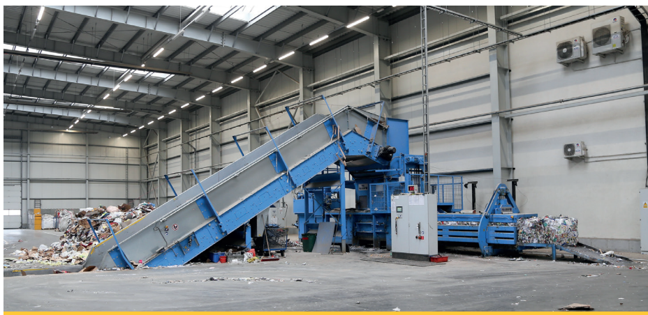
Belownica Paal Konti 425 H pracuje w zakładzie Eko-Wtór Jakubiec od jego uruchomienia w 2016 r. Do tej pory wykonała już ponad 30 tys. bel, serwis przyjeżdżał do niej tylko na planowane przeglądy okresowe.
