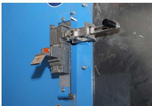
Maszyny Paal są wyposażone w unikatowy system bezpieczeństwa DOLD. Jest on oparty na specjalnych kluczach, które zapobiegają otwarciu jakichkolwiek drzwi czy otworów rewizyjnych bez wcześniejszego wyłączenia maszyny.
