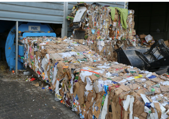
Bele wytwarzane w firmie SURIMET sp.j. na najnowszych Pacomatach mają 4-krotne wiązanie pionowe wykonane przy użyciu drutu o średnicy 3,2 mm.
