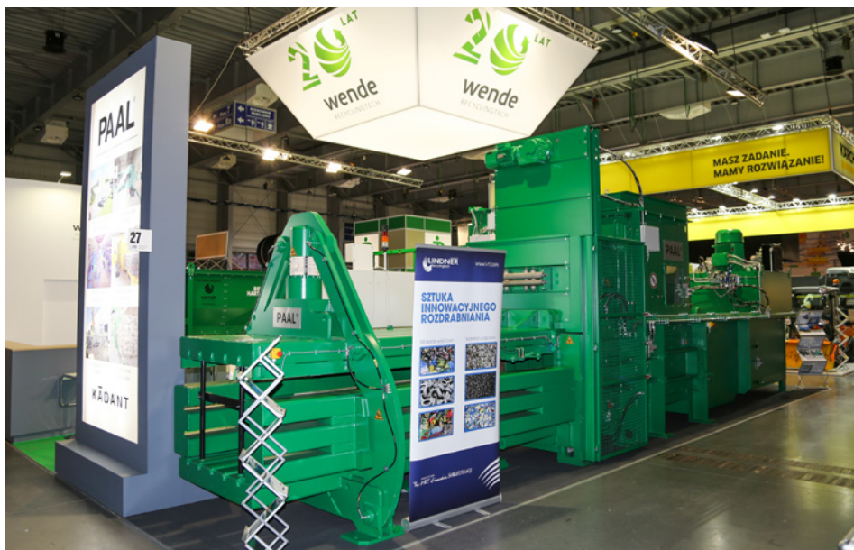
Belownicę kanałową PAAL Konti nowej serii „i”, dokładnie model V 325 i, można było zobaczyć na targach POL-ECO System 2018. Maszyny te wyróżniają się większą wydajnością oraz uproszczoną obsługą, m.in. poprzez wprowadzenie dodatkowych punktów centralnego smarowania.
