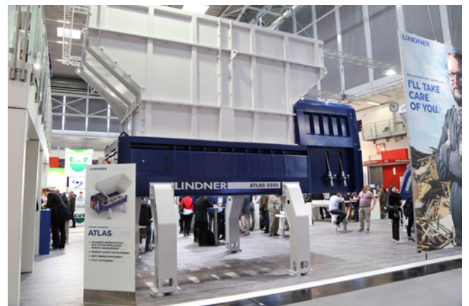
Dzięki innowacyjnemu napędowi elektrycznemu z systemem DEX, rozdrabniacz Lindner Atlas 5500 zawsze pracuje pod optymalnym obciążeniem i przy stałym poborze prądu z sieci energetycznej. W największym uproszczeniu działanie zastosowanego układu polega na wykorzystywaniu energii hamowania jednego wału do napędu drugiego, co również przyspiesza ich rewersowanie.
