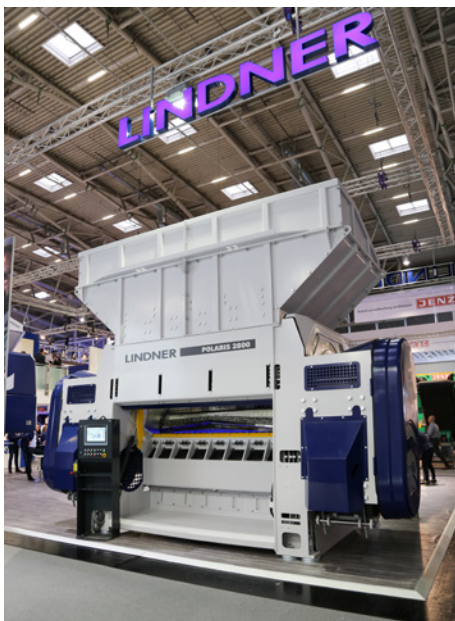
W rozdrabniaczach Lindner Polaris występuje wał pośredni, który razem z kołami pasowymi pełni rolę koła zamachowego. Według producenta akumulowana siła bezwładności ma w przybliżeniu wartość 11 t, dzięki czemu skutecznie przeciwdziała szczytowym wartościom obciążenia wału roboczego.
