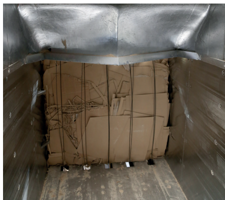
Gładka powierzchnia cięcia beli to efekt zastosowania opatentowanego noża w kształcie podwójnej litery „V”. Płyty z Hardoxu zostały wykorzystane nie tylko na podłodze, ale również na ścianach bocznych komory prasowania i kanału wyjściowego.
