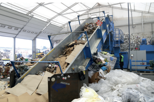
Oprócz samych belownic, firma Wende Recyclingtech dostarczyła wznoszące przenośniki taśmowe. Są one odpowiednio szerokie, co pozwala na lepsze rozłożenie materiału.
