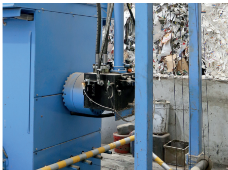
Blok hydrauliczny jest umieszczony na końcu siłownika głównego, a pompy w zbiorniku oleju, dzięki czemu w znaczny sposób ograniczono długość i liczbę przewodów hydraulicznych.
