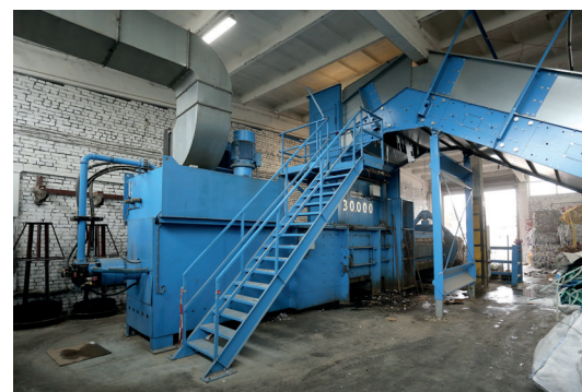
Jubileuszowa prasa Konti z numerem produkcyjnym 30.000 wciąż sprawuje się bez zarzutu, choć ma już siedem lat. Poza jedną wymianą płyt w kanale, które podlegają zużyciu eksploatacyjnemu nie wykonywano w niej żadnych poważnych napraw. PAALGROUP dużą uwagę poświęca kwestii bezpieczeństwa. Wszystkie maszyny są standardowo wyposażane w wygodne schody i szerokie podesty obsługowe z barierkami.
